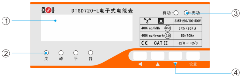
①LCD 屏 ②当前时段指示灯 ③电能脉冲指示灯 ④按键
